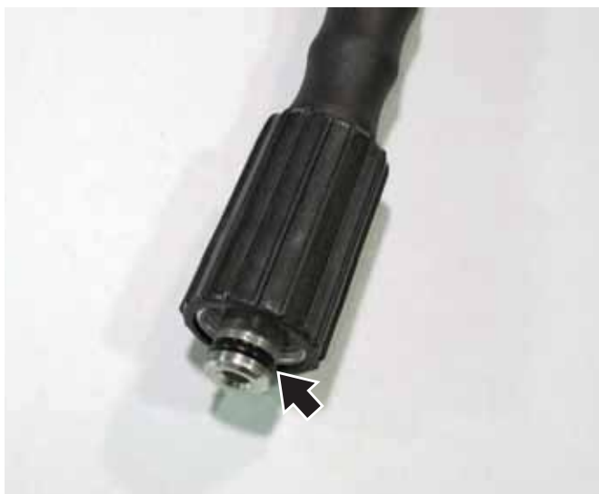
Figura 12 – Juntas tóricas de manguera de alta presión
