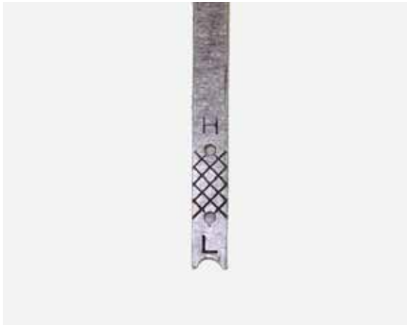
Figura 27 – Control del nivel de aceite
