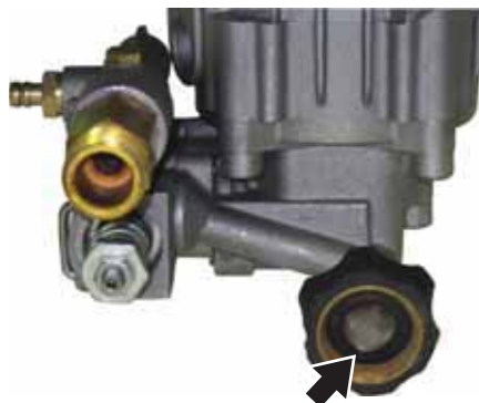
Figura 36 – Cedazo del filtro de agua
